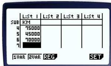
On accède donc aux calculs en appuyant sur  $\text{F2}$ . On a de nouvelles fonctions qui apparaissent. Nous effectuons pour l'instant des statistiques à une variable :  $\text{1VAR}$  qui correspond à la touche  $\text{F1}$
