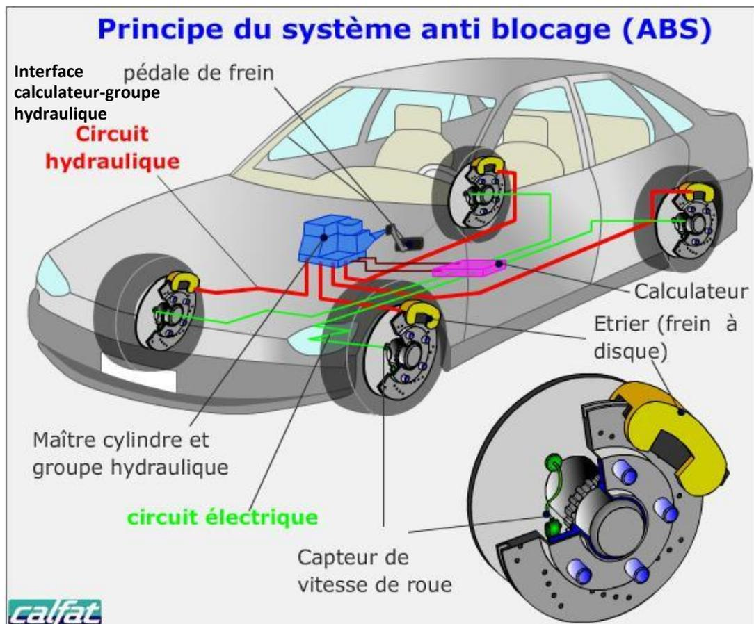
Le principe du freinage ABS est le suivant :
