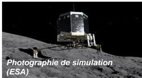
L'atterrisseur *Philaé*, transporte 10 instruments scientifiques dont un spectromètre de masse qui peut analyser les gaz et les molécules organiques prélevés dans le sol.
