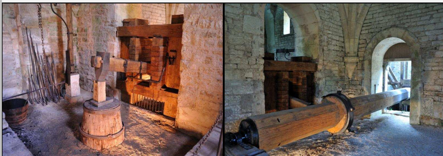
Au XIIème siècle, l'arbre à cames, entraîné par la roue du moulin, permettait d'actionner le martinet.
